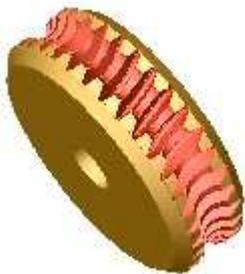
**Attention** : cette fonction se contente de donner un usinage fictif des creux de denture : le profil est celui d'une denture droite de module égal au module normal de la vis, différent du profil réel généré par l'engrènement de la roue sur la vis; le creux est généré par un balayage sur un cercle incliné de l'angle de roue  $\beta$ , différent du creux réel hélicoïdal
